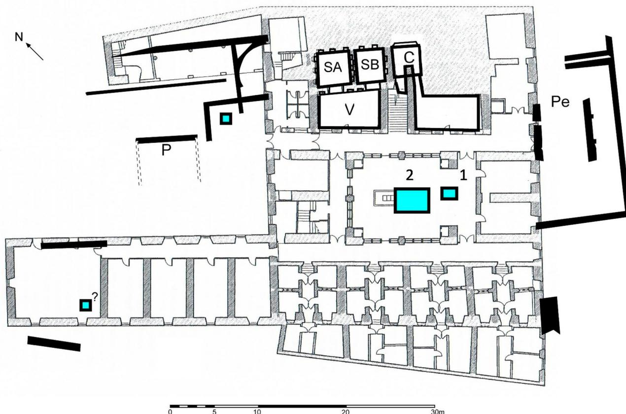
Figura 2: Planta esquemática del establecimiento de baños actual, con las estructuras romanas conservadas (en oscuro) y la localización de las estructuras citadas en este artículo: 1 = Pozo receptor; 2 = Pozo-estaque. A partir del plano de Arias Vilas (1997, 349) y Meijide y Hervés (2000).
